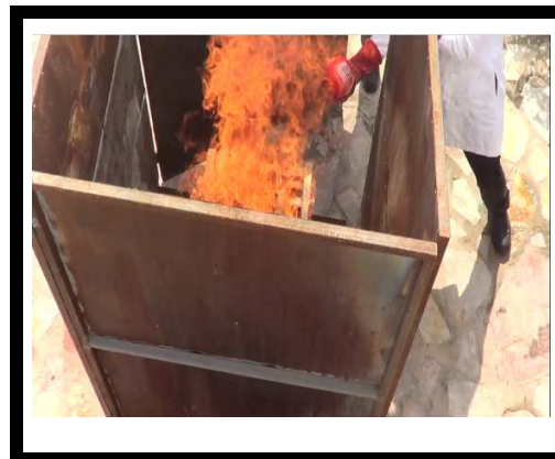
VISTA DE LA APLICACIÓN DEL SUPRESOR DE FUEGO A LOS 3 MINUTOS DESPUES DE HABER ENCENDIDO EL COMBUSTIBLE
