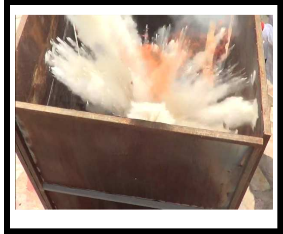
VISTA DE LA EXPLOSION DEL SUPRESOR DE FUEGO
