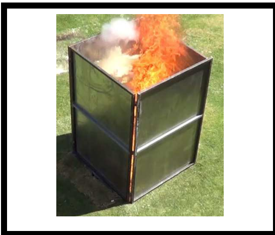
VISTA AREA DESDE "DRON" AL INICIO DE EXPLOSION DEL SUPRESOR DE FUEGO
