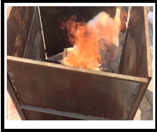
VISTA DEL INICIO DE EXPLOSION DEL SUPRESOR DE FUEGO
